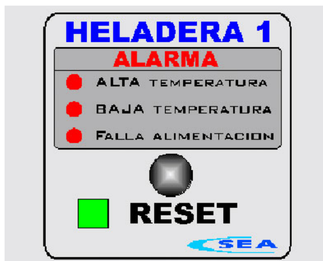
Figura 4. Panel de alarma de temperatura con botón de reset.
