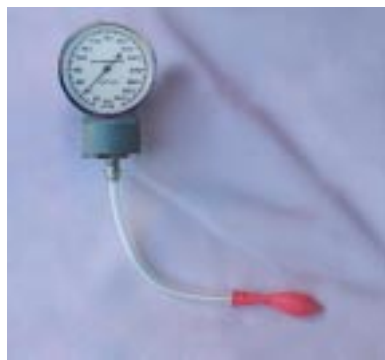
Figura 11. Manómetro utilizado para medición de presión del vendaje.
